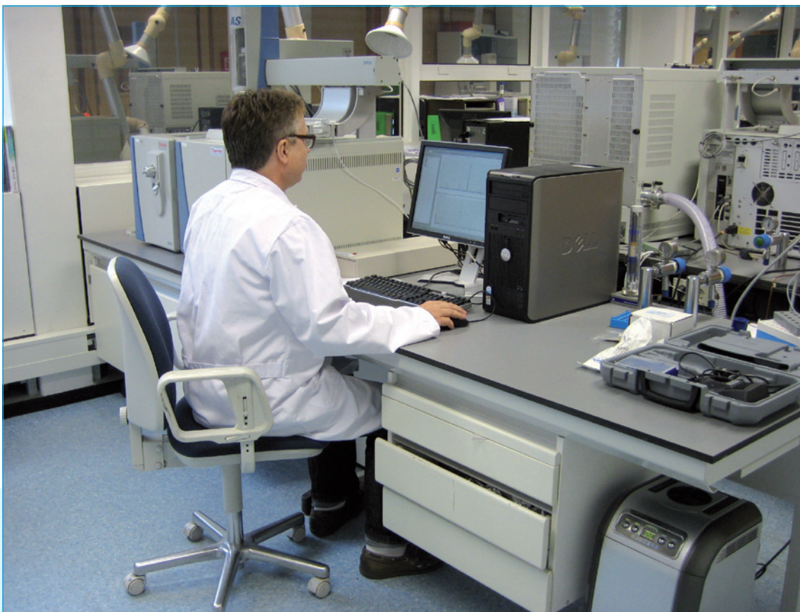
Figuur 12. Analist Richard Kerkhoff van het Waterlaboratorium aan het werk met de GC-MS voor de brede screening van stoffen in oppervlaktewater.
