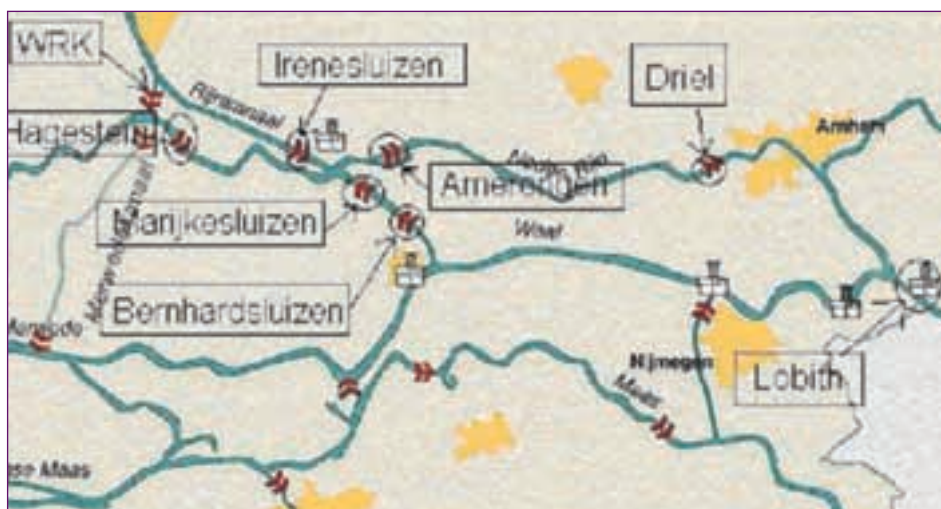
Figuur 2-2: Sluizen en stuwen op het traject Lobith – Pannerdensch kanaal – Nederrijn – Lek
