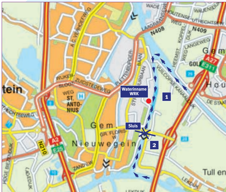
Figuur 3-12: Situatie kortsluitstromen Amsterdam-Rijnkanaal richting Lekkanaal
