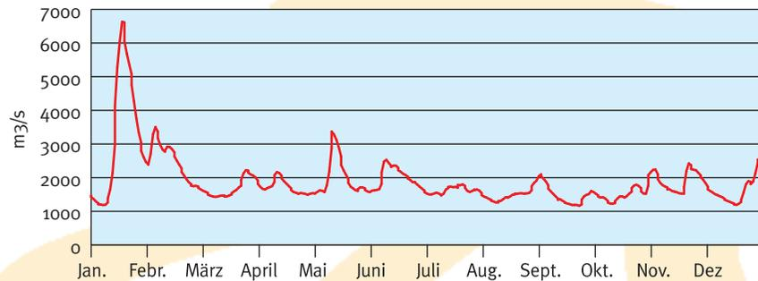
Der Wasserabfluss bei Lobith schwankte im Jahr 2004 zwischen 1160 und 6630 m³/s. Dieses Muster entspricht dem des Jahres 2003; in den ersten Monaten lässt sich demnach ein Anstieg erkennen und danach erfolgt ein ziemlich gleichmäßiger, geringer Abfluss.
