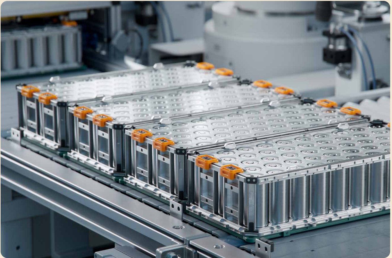
Lithium-Ionen-Hochspannungsbatteriekomponente für Elektrofahrzeuge oder Hybridautos in der Fertigungslinie.
